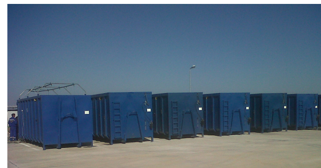
(4) COCCINELLE® PER REAZIONE AEROBICA DI BIOSTABILIZZAZIONE
