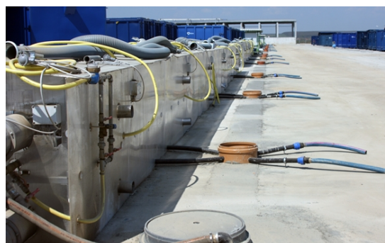
(2) SISTEMA AERAZIONE FORZATA PER ACCELERARE LA REAZIONE
